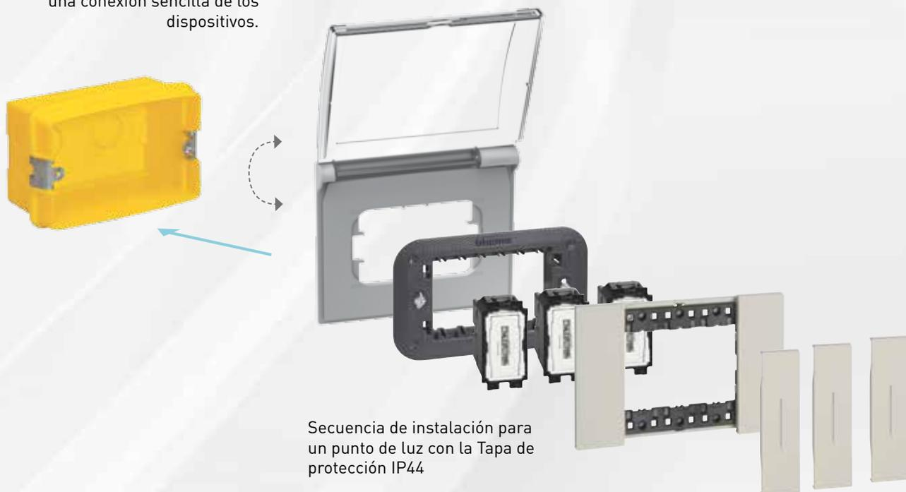
Secuencia de instalación para un punto de luz con la Tapa de protección IP44
